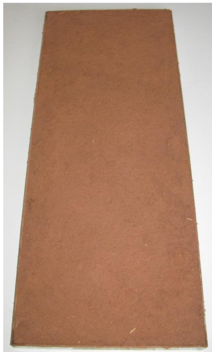
Ilustração 2: Superfície absorvente, Mistura de reboco de argila EMBARRO Universal
