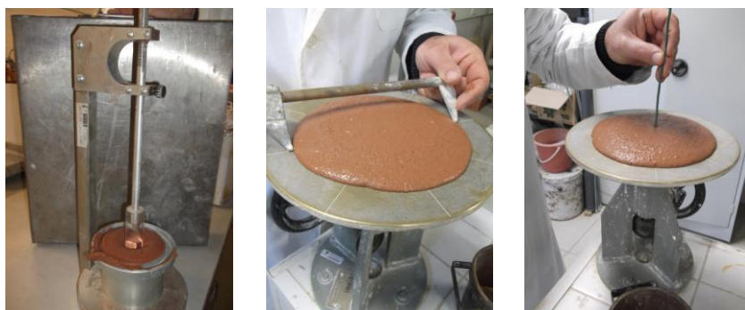
Figura 2. Ensaio da consistência por penetrómetro (esquerda); ensaio da consistência por espalhamento (centro); ensaio de abaixamento (direita)
