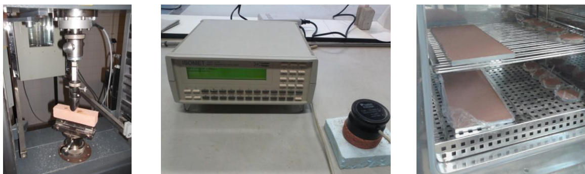
Figura 3. Ensaio de resistência à tração por flexão (esquerda); ensaio de condutibilidade térmica (centro); ensaio de adsorção de vapor de água (direita)
