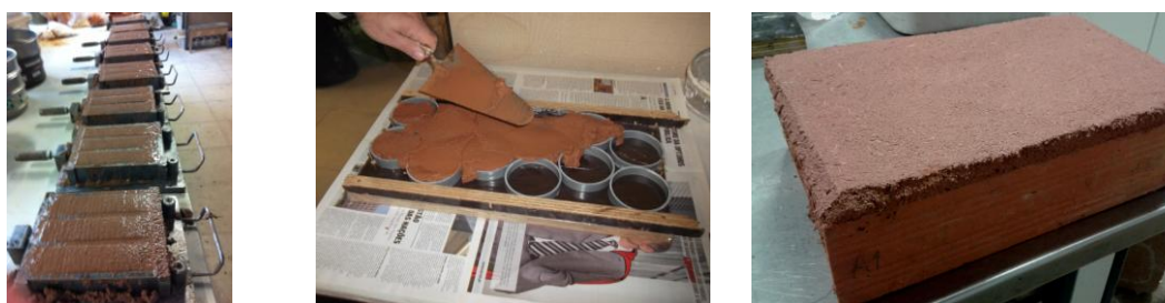
Figura 1. Provetes prismáticos de 40x40x160 [mm] nos moldes (esquerda); preparação dos provetes circulares (centro); provetes de argamassa sobre tijolo (direita)
